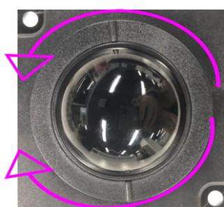
Pour retirer la bague de fixation, faire pivoter dans le sens anti-horaire
